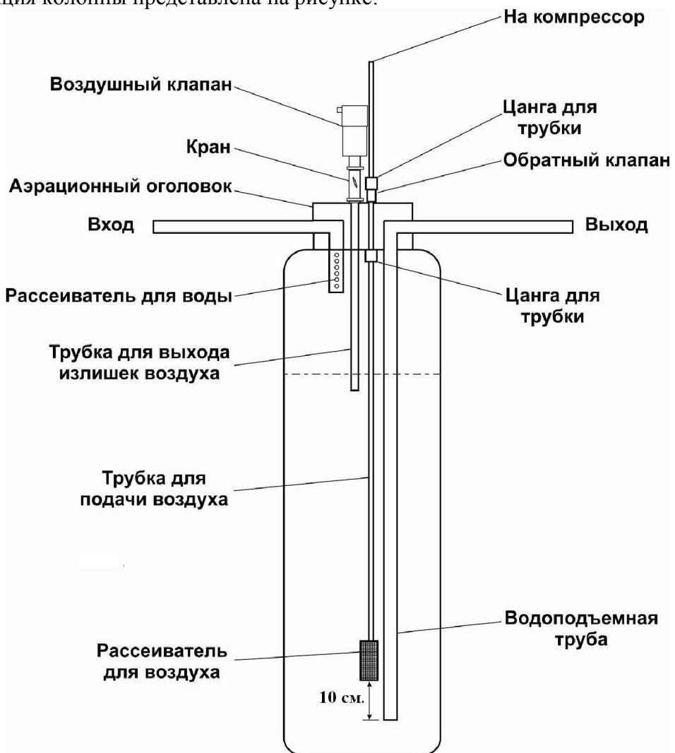
В горловину колонны с резьбой 2,5" вкручена распределительная шайба, имеющая с наружной стороны резьбовые отверстия для подвода и отвода воды (1") и отвода воздуха 3/8".
